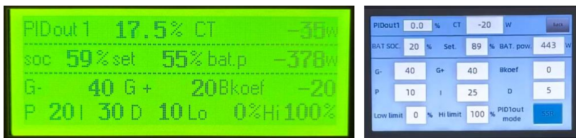
Výstup 1 - detailní nastavení PID regulace výstupu č. 1
